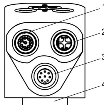
1. M12 plug: Inputs/Outputs
