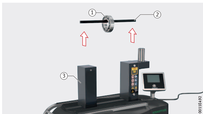
Obrázek 48 Vyjmutí zavěšeného ložiska z opěrné lišty
