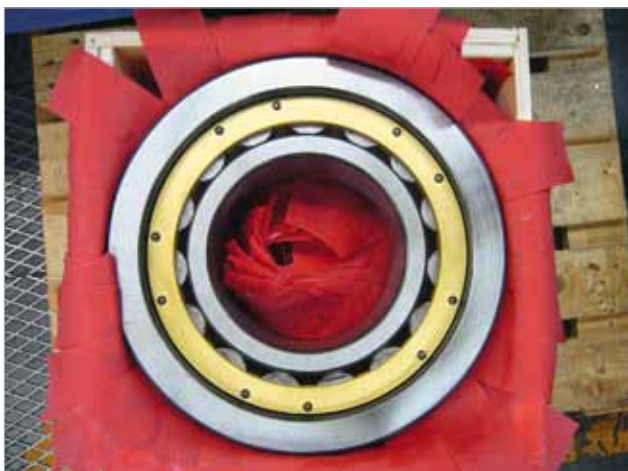
Při prořezávání červené smršťovací fólie vznikly zářezy na vnějším kroužku ložiska. Vnější kroužek je příliš měkký, vnitřní kroužek zase naopak příliš tvrdý a konstrukce klece je riskantní – ložisko je tak předurčeno k selhání.
