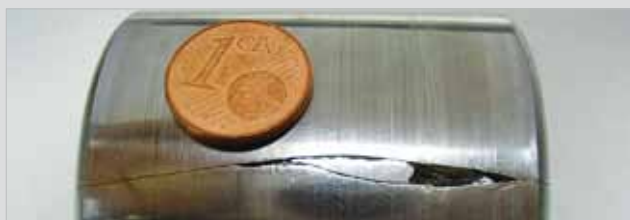
Prasklé duté valivé těleso ložiska způsobilo kvůli následným prostojům značnou škodu.
